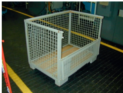
Abbildung 2: Euro-Gitterboxpalette [Großladungsträger] (1200 x 800 x 970)
