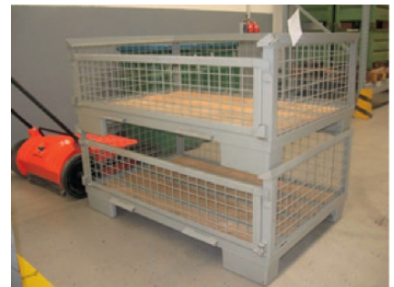
Abbildung 3: Euro-Gitterboxpalette-halb [Großladungsträger] (1200 x 800 x 500)
