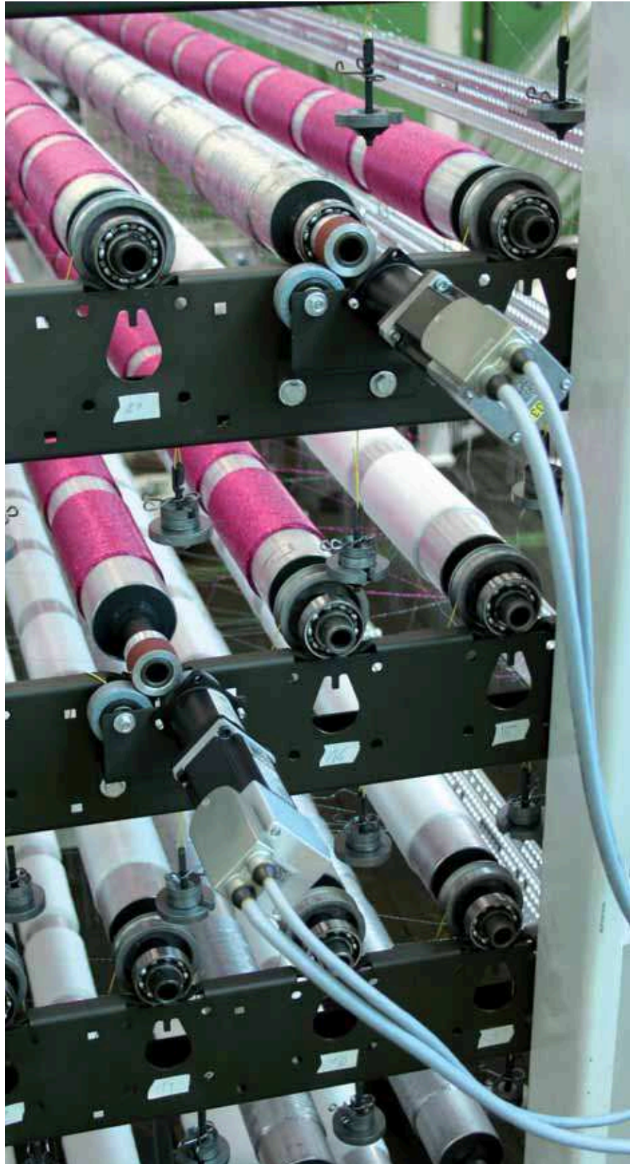
Abb.: Servosystem mit Lagerung der neuen aktiven Musterfadenzulieferung
